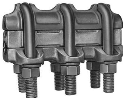
Estos conectores están especialmente indicados para la conexión de conductores de Aluminio o ACSR (ranura superior) a conductores de Cobre (ranura inferior). Las piezas que conforman la ranura inferior, tienen sus caras de contacto revestidas con una placa de Cobre unida mediante un proceso metalúrgico para proporcionar un contacto confiable.
