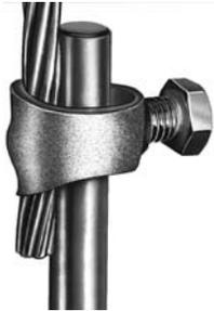
Permite la conexión de un cable de Cobre de puesta a tierra en forma paralela a un electrodo macizo. Está construido en Bronce aleado de alta resistencia especial para aplicaciones con gran par de apriete.
