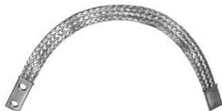
Estos puentes flexibles para puesta a tierra, están contruidos con férulas de Cobre sin costura comprimidas sobre una trenza de alambre de Cobre y se utilizan en combinación con las grapas GC-109. Cada alambre de Cobre se estaña antes del trenzado. Una de las férulas tiene agujeros espaciados según NEMA y la otra es ciega.
